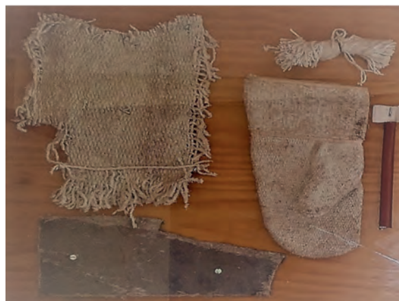
Figura 2 y 3. A la izquierda, plancha de fibrocemento (más conocido en nuestro país por su nombre comercial, uralita). A la derecha, diferentes productos que contienen amianto, entre ellos, prendas textiles.
