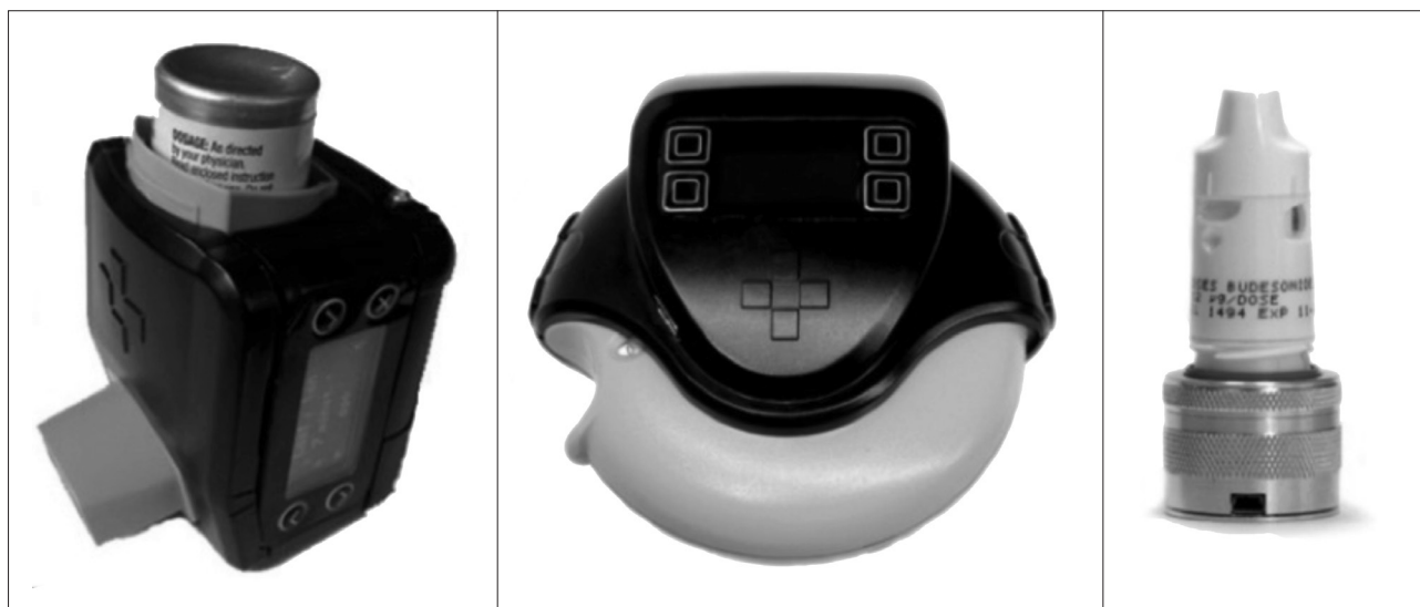
Figura 1. Smartinhaler ( http://www.smartinhaler ) para los dispositivos de cartucho presurizado, turbuhaler y accuhaler.
